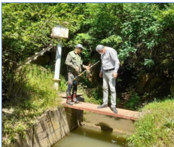
شکل ۸- خواندن ارقام مربوط به ارتفاع یا عمق رواناب به‌روش دستی و با استفاده از اشل (فلوم حوضه شاهد)
