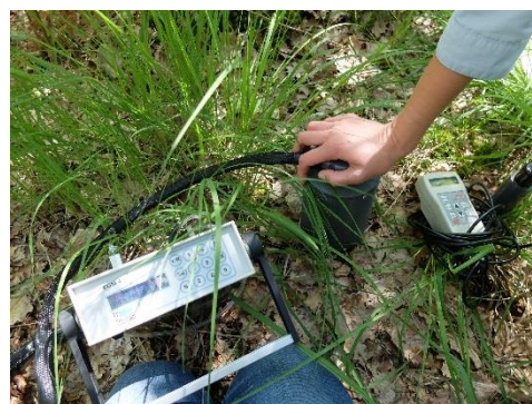
شکل ۲- اندازه‌گیری میزان تنفس کلی خاک (تنفس میکروارگانیزم‌ها و ریشه درختان) توسط دستگاه قابل حمل. توضیح: تصاویر مربوط به تحقیقات نگارنده اول در جنگل‌های فرانسه است.
