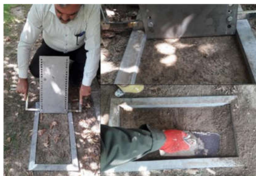
شکل ۲- مراحل استفاده از دستگاه نمونه بردار صفحه خراش دهنده
